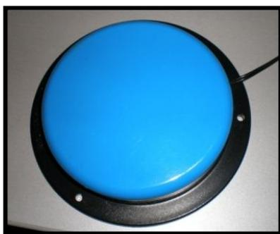
A sua utilização é muito simples, através da pressão exercida no manipulo (com qualquer parte do corpo), este faz ativar uma função no dispositivo ao qual se encontra ligado.
