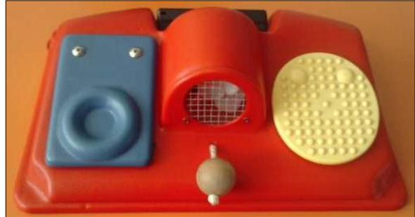
✚ **Brinquedos Adaptados:** São brinquedos com um sistema eletrônico simples que são adaptados através da colocação de uma ficha *Jack* à qual podem ser ligados vários manípulos (Switch). Fazendo, deste modo ativar a ação produzida pelo brinquedo.
